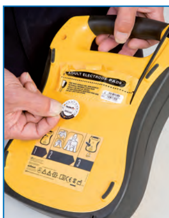
7. Aanbrengen onderhoudsetiket, registratie logboek
